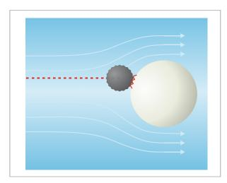
Größere Partikel verlassen durch ihre Trägheit bei einer Umlenkung des Luftstroms durch eine Filterfaser ihre Flugbahn und prallen so geradewegs auf die Filterfaser auf, an der sie schließlich hängen bleiben.
