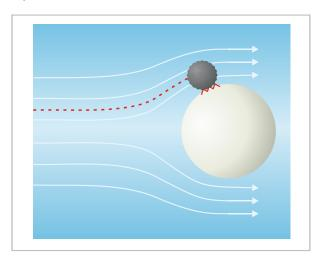
Kleinere Partikel folgen den umgelenkten Luftstrom um die einzelnen Filterfasern. Kommen die Partikel dabei zu nah an eine Filterfaser heran, bleiben sie hängen und werden so am weiteren vordringen gehindert.
