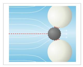
Partikel die größer sind, als der Freiraum zwischen den einzelnen Filterfasern, bleiben hängen und werden so vom Filter abgefangen.
